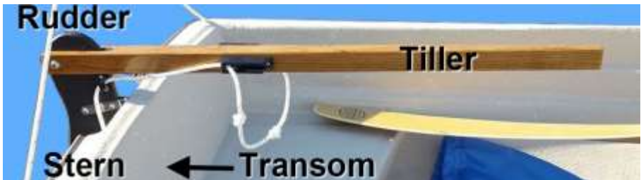
Fig. 10. Rudder, Tiller, Transom
